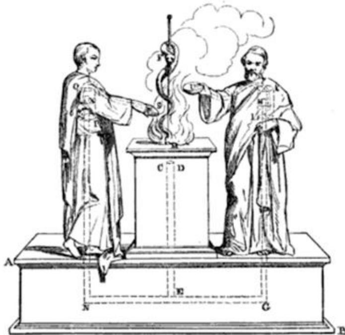
El aire caliente que se mezcla con el agua, pasa a lo largo de los tubos del cruce horizontal, y los atraviesa y ejerce presión sobre el vino, y lo lleva a través de los sifones curvados R S y T U.
