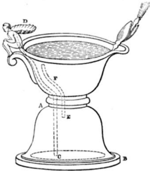
Desde éste se extienden dos tubos, C D, E F, que se comunican con el recipiente; el extremo C debe llegar hasta el fondo dejando un espacio para dar paso al agua y el tubo C D hasta la superficie de la lámpara, teniendo el extremo D una pequeña copa a través de la cual se vierte el agua dentro: el tubo E F debe pasar herméticamente, a través del fondo de la lámpara.
