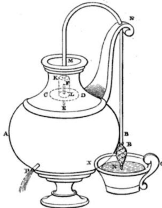
Pero si se inclina ligeramente hacia abajo el tazón, se vacía una porción del brazo del sifón, y en esta parte vacía el aire próximo es succionado: este aire absorbe un poco del agua vertida en el cuello, de modo que el agua sube a la boca F; y por consiguiente, el aire encuentra una entrada, opera la boquilla P hasta que se empuja de nuevo el tazón O X, haciendo que el agua retorne a su antigua posición y cierre el paso del aire de tal modo que la boquilla cesa el flujo.
